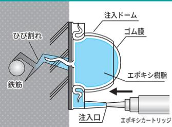
**注入ドーム工法の仕組み**
