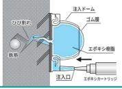
注入ドーム工法 の仕組み
